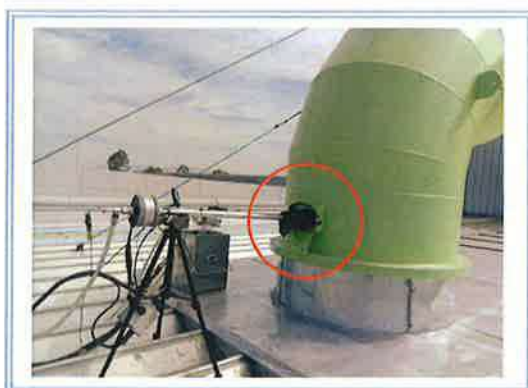
ปล่องระบายอากาศ เครื่องทุบขึ้นรูป 4500T
